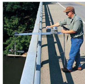
Mjerenje hidrometrijskim krilom sa mosta
